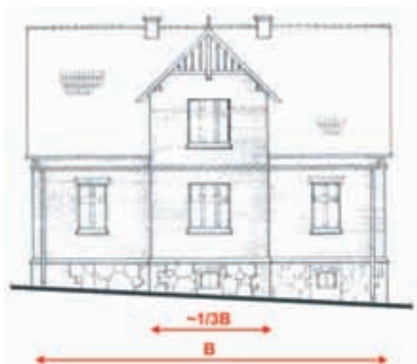
Ryc. 5.26. Proporcje ryzalitu osiowego na ścianie podłużnej przykładowego budynku o klinkierowej elewacji z Dziewiętlna. (oprac. autor).
