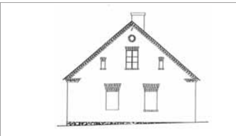
Ryc. 5.21. Elewacja budynku z Dziewiętłina. Lico muru tynkowane, nadproża o łuku prostym, gzyms i medalion na zwieńczeniu szczytu ceramiczne, cokół z brył rudy darniowej. Rysunek ze zbiorów Studenckiego Koła Naukowego Budownictwa, Uniwersytet Przyrodniczy we Wrocławiu. Prace wykonane pod kierunkiem autora.
